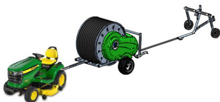
Descendez le traîneau conformément à la description sous schéma d'opération I, chapitre "Descendre le traîneau" et ancrez-le légèrement. Ensuite conduisez l'appareil à travers le champ.
