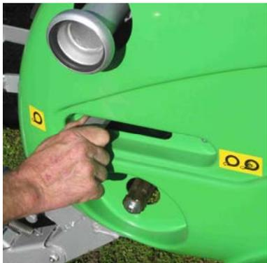
Lorsque la pression d'opération est atteinte et de l'eau sans air sort du canon, mettez le levier de changement de vitesse à la position "Enroulement du tube PE".
