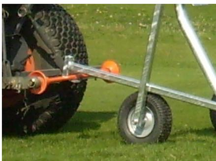
La barre d'attelage du tracteur est accrochée dans ce crochet et le tube PE est détaché. Quand le Rainstar change sa position, le traîneau doit être à sa position finale.
