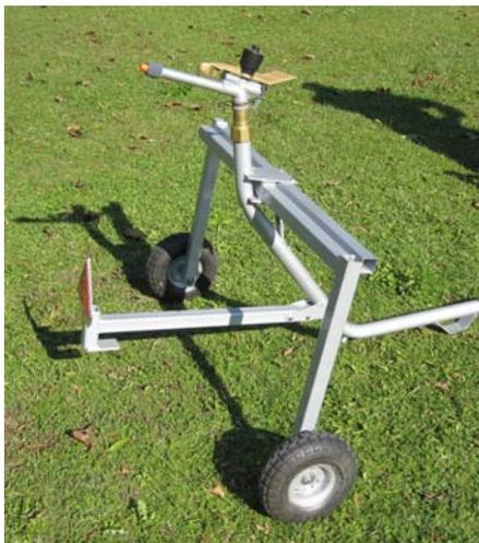
Grâce à sa haute construction, le traîneau à roues protège très bien les cultures. La voie est réglable en continu permettant l'ajustage à n'importe quel écartement entre rangées. Le traîneau est équipé d'un crochet pour faciliter le détachement du tube PE.
