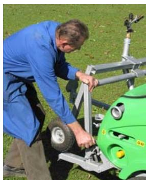
Desserrez le frein de tambour et en même temps pressez le traîneau à roues avec le lève-traîneau et la béquille dans le sol.
