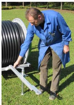
Mettez l'appareil dans une position horizontale à l'aide de la béquille de timon.
