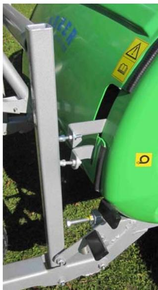
L'appareil est équipé d'un arrêt final ainsi que d'un arrêt de sécurité qui rendent inutile la surveillance de l'opération d'arrosage. L'arrêt final répond dans le moment où le lève-trainneau actionne la console d'arrêt au levier de changement de vitesse. L'entraînement est arrêté. Pour éviter des inconvénients lorsque le tube PE est mal enroulé, la barre palpeur déclenche également l'arrêt.
