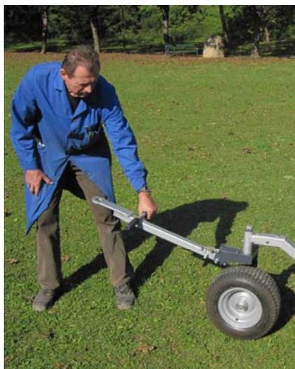
Avec l'option d'un châssis à 3 roues, il est facile de mettre le RAINSTAR à sa position de travail souhaitée.
