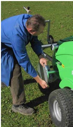
Pendant l'entraînement par cardan l'arrêt final automatique est hors service. Il faut donc arrêter à temps l'arbre cardan et enrouler à main la dernière partie du tube en se servant de la roue à main. On évite ainsi l'endommagement par violence du traîneau, du dispositif d'arrêt, de l'engrenage, etc.
