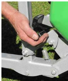
Déverrouillez le crochet de sécurité de transport du lève-traîneau.
