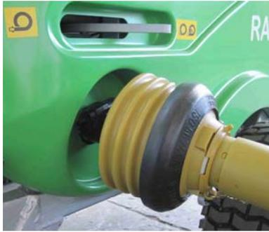
Le cas échéant le tube PE peut également être enroulé par le tracteur à l'intermédiaire d'un cardan. Mettez le levier de changement de vitesse à la position "Enroulement par tracteur".
